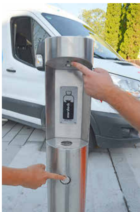
Oben ist ein Sensor eingebaut, der erkennt, wenn sich eine Flasche, ein Becher oder eine Hand unter der Düse befindet. Unten ist der Druckknopf, mit dem das Wasser zusätzlich eingeschaltet wird.
