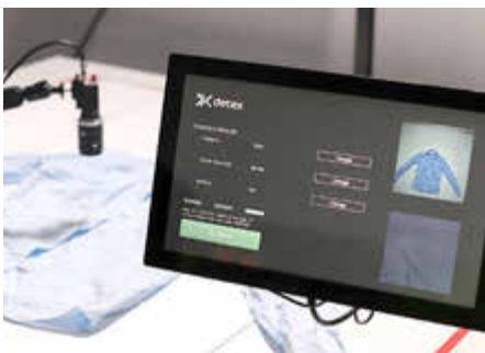
Mit Künstlicher Intelligenz lässt sich die Textilqualität schneller erkennen. Foto: ITA Augsburg gGmbH
